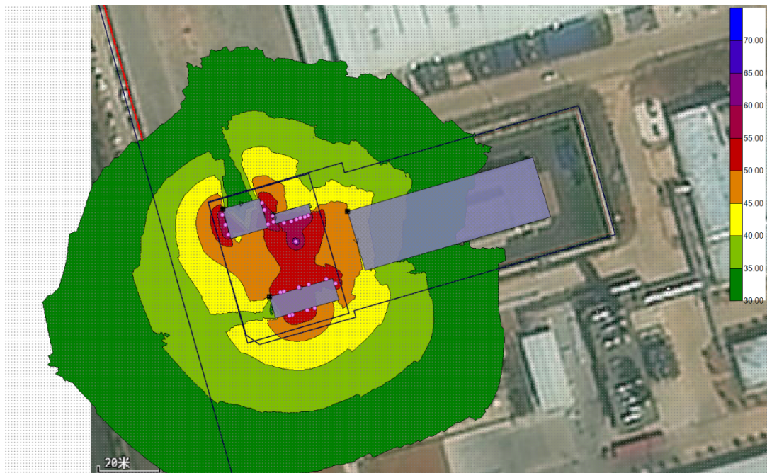
图 4-3 本项目变电站（预测点高度 1.2m）噪声预测等声级线图
