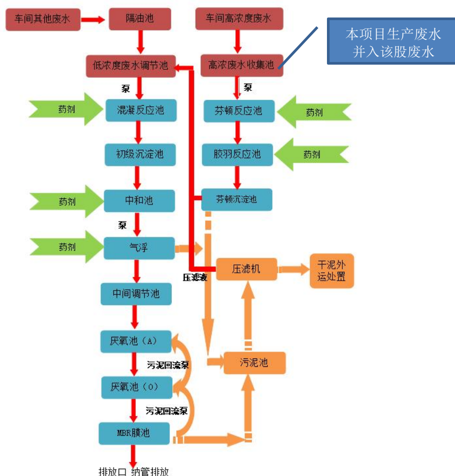
图4-2 海天塑机污水处理设施流程图
