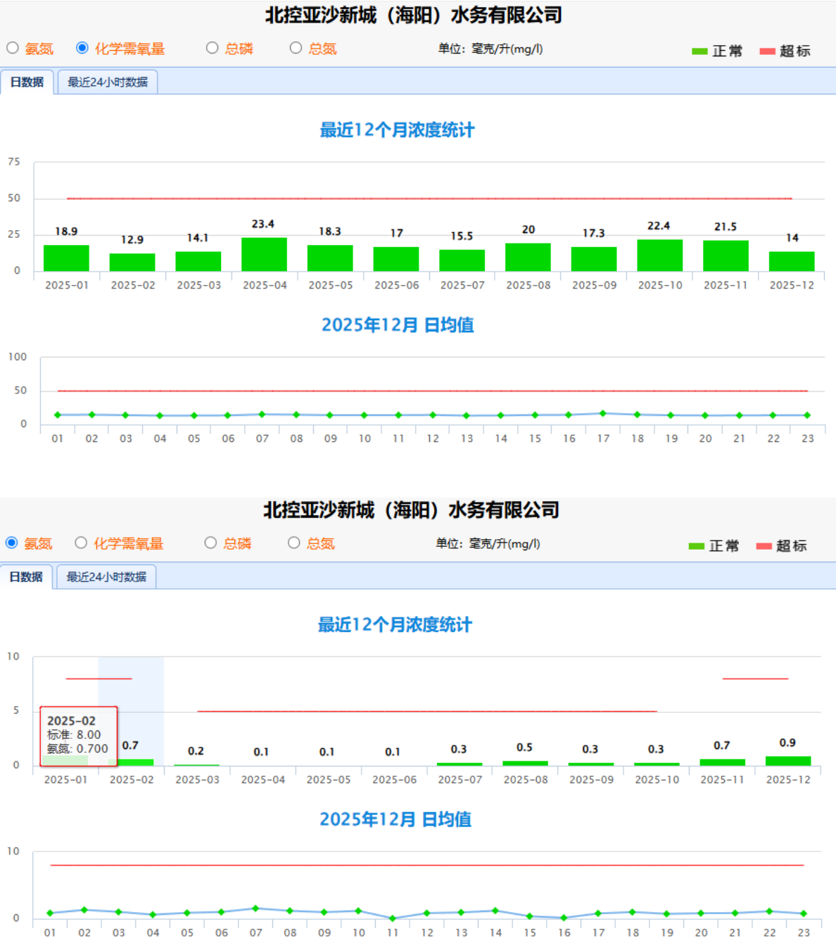
图 6.2-2 亚沙城污水处理厂出水在线监测数据
